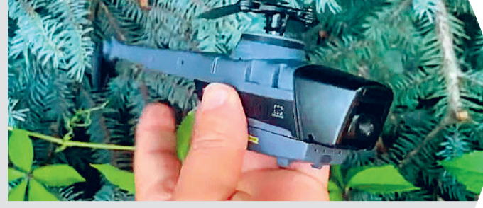
महज 33 ग्राम है वजन : कीट आकार के इस ड्रोन को ब्लैक हॉर्नेट कहा जाता है जिसका वजन सिर्फ 33 ग्राम है। यह नोंके का है जो बहुत महंगा है। यह मूल रूप से एक छोटा सा हेलीकॉप्टर जैसा है जिसमें टिवन रोटर लगे हुए। इसकी रेंज करीब बी किलोमीटर की है। इनका इस्तेमाल वर्तमान में भारतीय सेना की राष्ट्रीय राइफल्स और विशेष बल कर रहे हैं।
